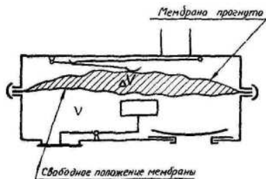
Рис. 4 Основной и дополнительные объемы подкрышечной полости.
